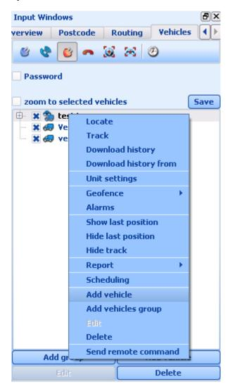
Dans le fenetre Reglage du véhicule permetez le Commande a distance. Saisissez l'adresse IP statique por la connection GPRS ( laissez vide pour VTU )
